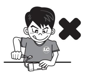
DO NOT DISASSEMBLY BATTERY OR CUT BATTERY CABLES. バッテリーの分解、バッテリーケーブルの切断はしないで下さい。 If the running battery short - circuits, approx. 300W of electricity can be discharged, leading to fire or burns. Never disassembly battery or cut battery cables. バッテリーをショートさせてしまうと約300Wの電流が流れます。 火災や火傷の原因となりますので絶対にバッテリーの分解とケーブ ルの切断は行わないで下さい。
